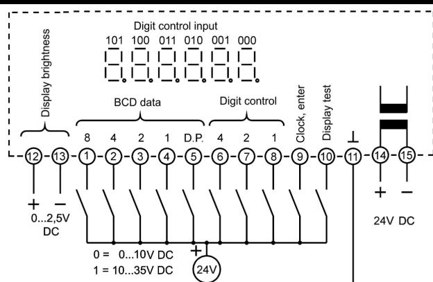
Utilisation avec polarisation des entrées TOR par la tension d'alimentation
